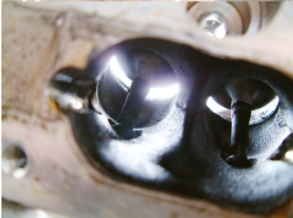
Auf den Bildern erkennt man ganz deutlich die Ablagerungen auf den Ventilen und Schäften. Blick ansaugluftseitig durch den Zylinderkopf in Richtung Brennraum durch die Ventilöffnung.
